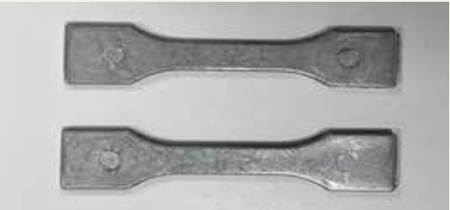
Provini pronti per essere testati (spessore 3 mm)
