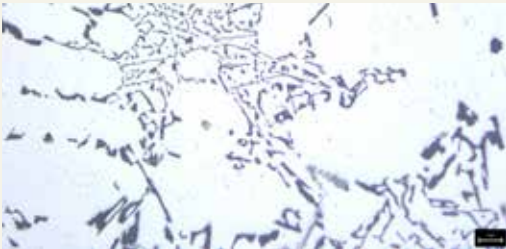
Microstruttura della lega senza Sr (ingrandimento 500x)
