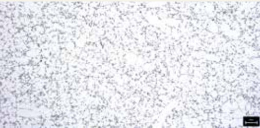
Microstruttura della lega allo stato T6 (ingrandimento 200x)
