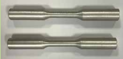
Provini pronti per essere testati (diametro del tratto utile 6 mm)
