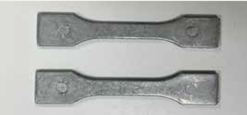
Provini pronti per essere testati (spessore 3 mm)
